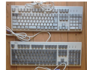
図6 キーボードへの施工例（下側灰色の部分が earthplus）
